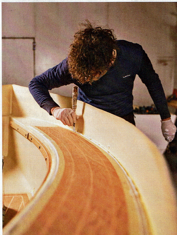
La reproduction des gestes. Clément lisse soigneusement un joint en silicone à l'aide d'une gouge à bois.
