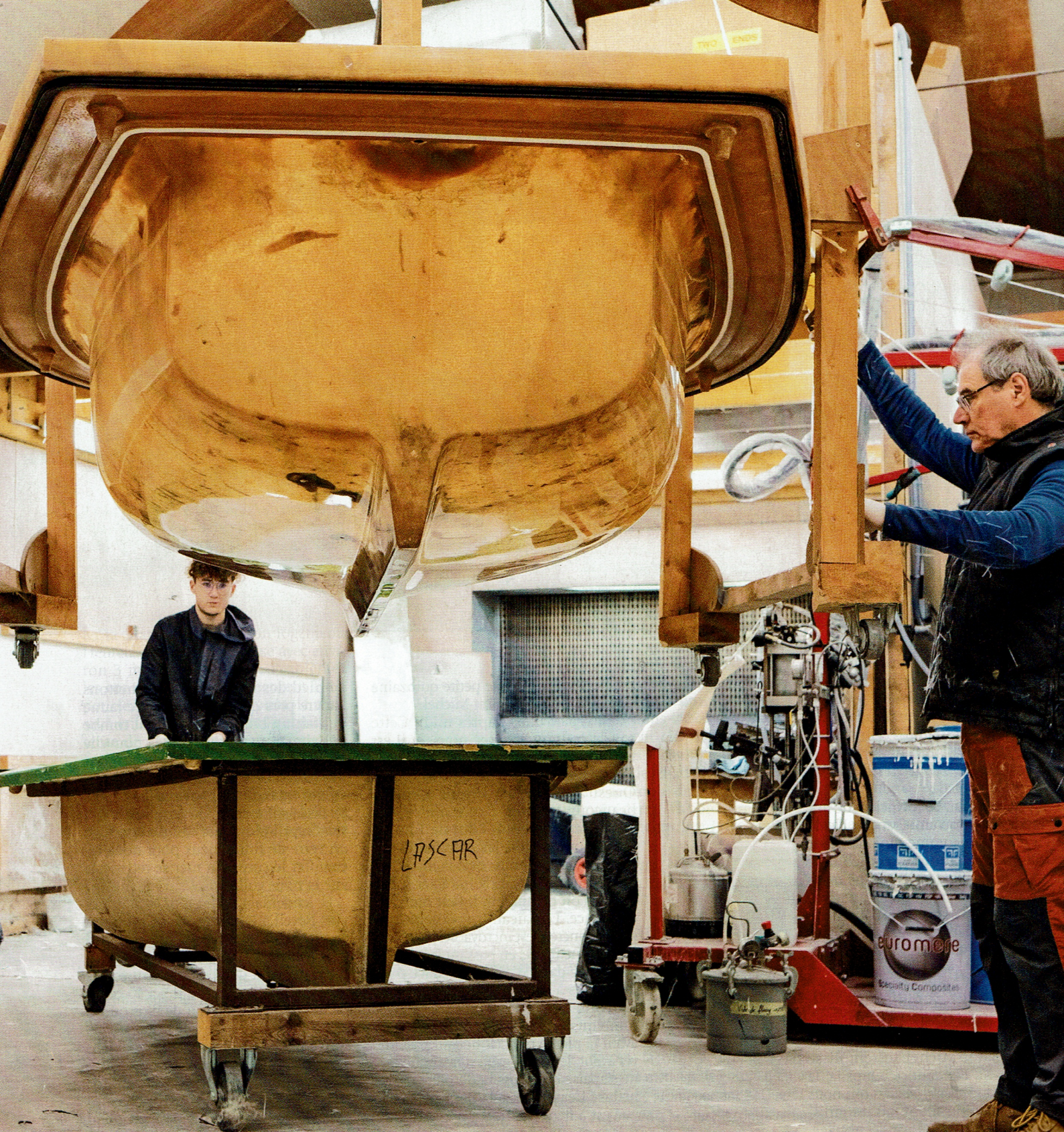
Un ballet bien orchestré. Dans l'atelier composite, Clément (à gauche) et Patrick (à droite) préparent avec soin les moules pour l'injection.
