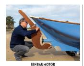
Im Ausschnitt des angehängten Ruders quirlt ein Kunststoffprop, der von einem kleinen Elektromotor angetrieben wird
