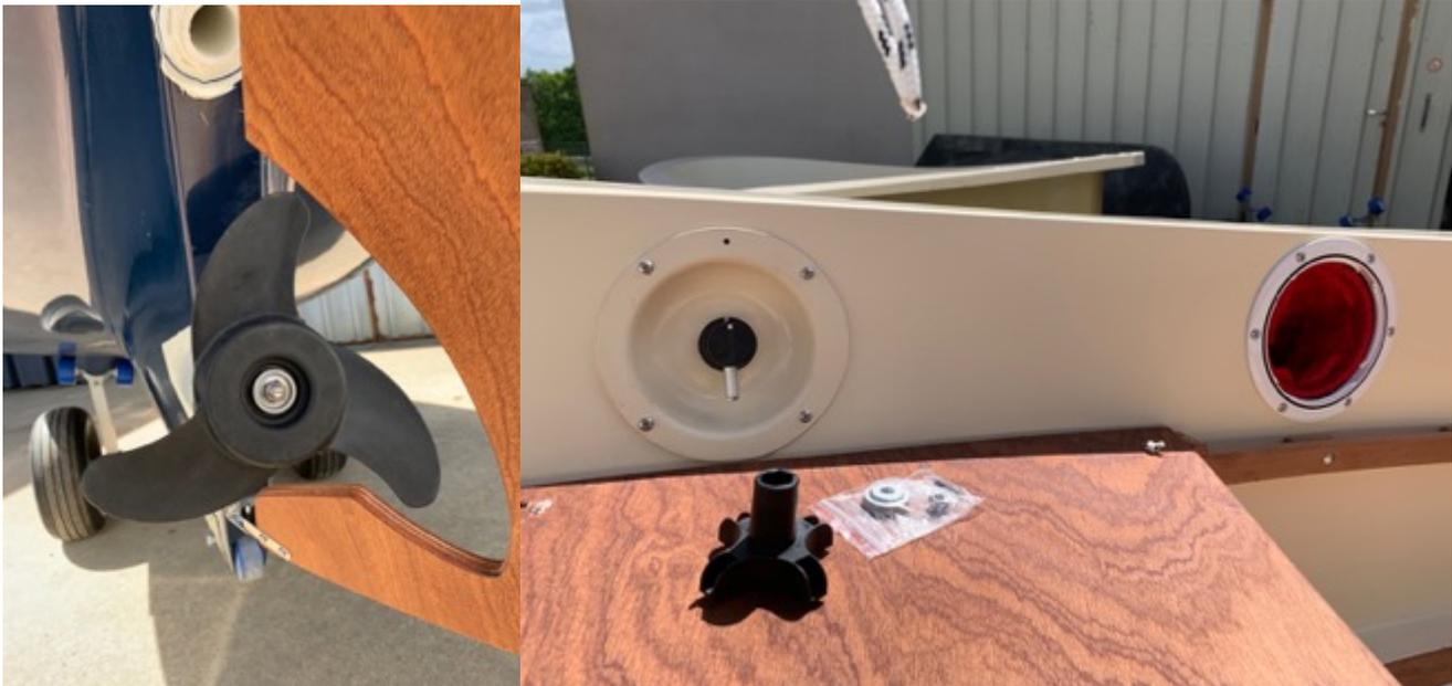
Pour Gazelle des Iles uniquement, si option moteur électrique commandée : potentiomètre, anode, clavette et dévisseur à babord
