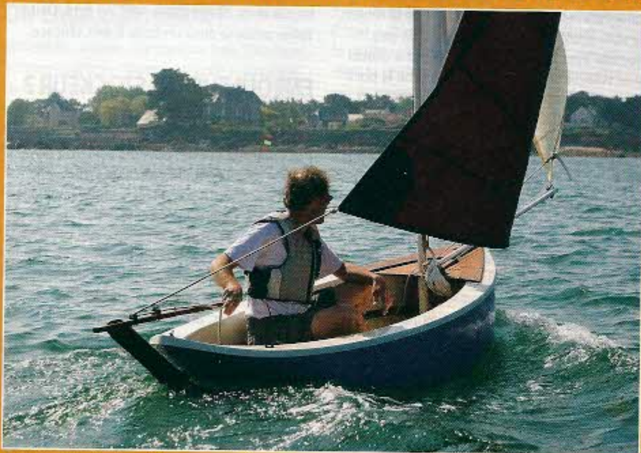
Le foc est autovireur, le barreur ne gère que la barre et l'écoute de grand-voile.
