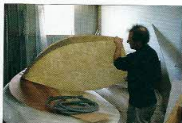
Patrick est un artiste du composite. Ici, il manipule une mini-coque qu'il a dessinée puis fabriquée en fibre de lin. Un projet parmi d'autres.
