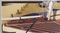
**Pratique** La double emplanture de mât permet de passer du cat boat au cure en fonction de la météo.
